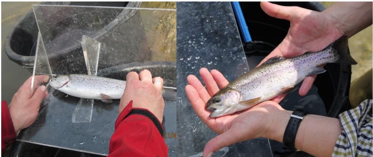
Joonised 26 ja 27. Kalade mõõtmine (vasakul) ja hindamine (paremal) pärast hüdroenergiakruvi läbimist.
